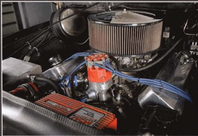
Power-Motor mit selbst geschweißten Ventildeckeln
